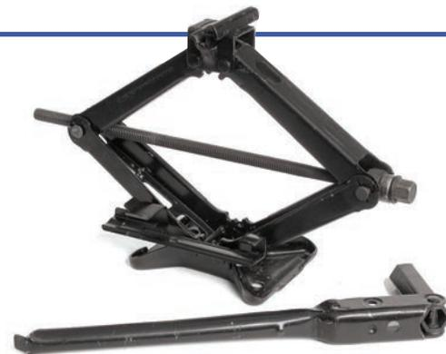
Un système à vis et à écrou dans un cric pour soulever une voiture
