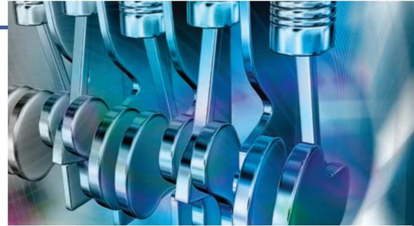
Un système à bielles et à manivelles dans un moteur à combustion interne
