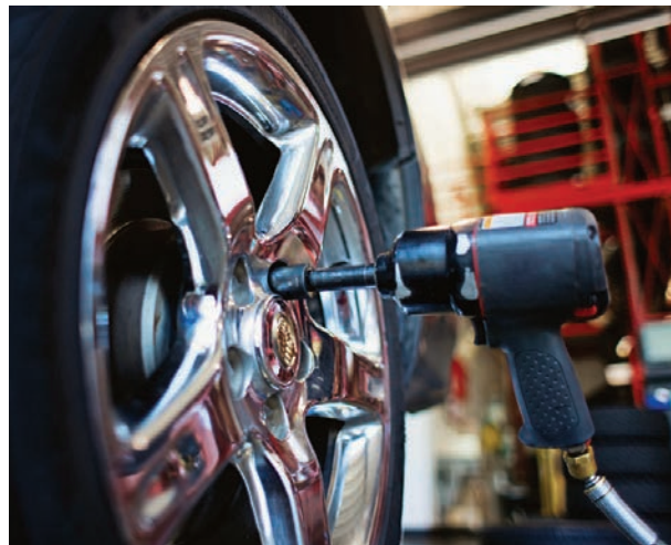
► 1.3 Une boulonneuse pneumatique fonctionne à l'aide d'air comprimé.
