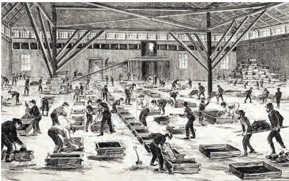
3.21 Une fonderie et un atelier de moulage, à Montréal, en 1872. Cette année-là, l'usine Clendinning emploie 180 personnes, dont 17 % ont moins de 16 ans. Sa production mensuelle est d'environ 5000 fourneaux et poêles, 1500 montants de lit et 2000 tonnes de matériel ferroviaire et agricole.
