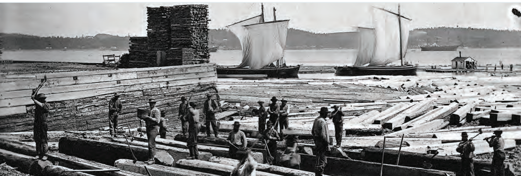
3.46 Du bois équarri à Sillery, près du port de Québec, en 1891. Une fois découpé à la hache, le bois est ensuite exporté par bateau vers l'Europe ou les États-Unis.
